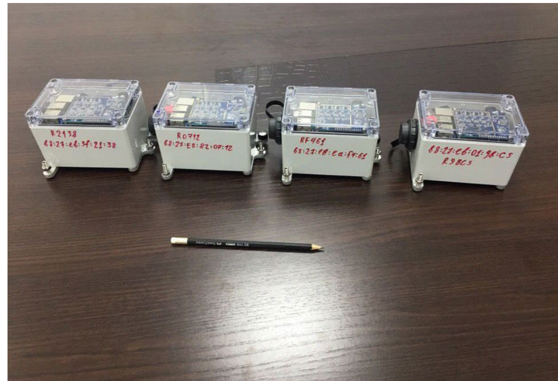
◀ Прибор для измерения инерционного ускорения. Источник: Алексей Коновалов
