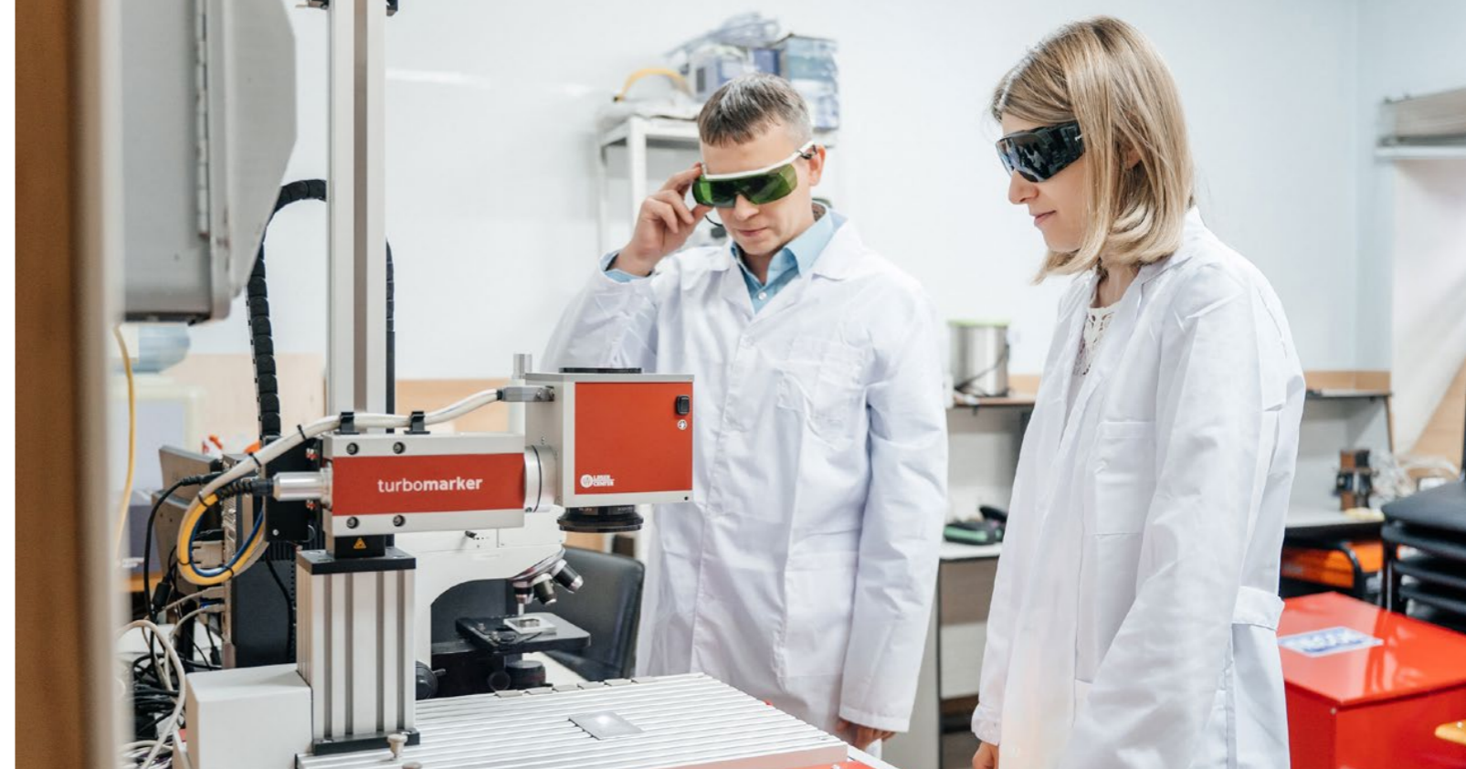
Модификация текстуры поверхностей металлов и керамики лазерным излучением. Источник: Дмитрий Феоктистов
